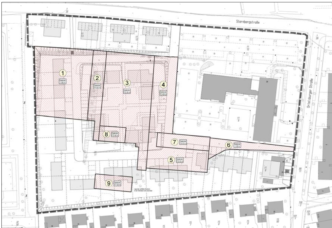
verunreinigte Bereiche mit Angabe der Höhenlage nach Abtrag
