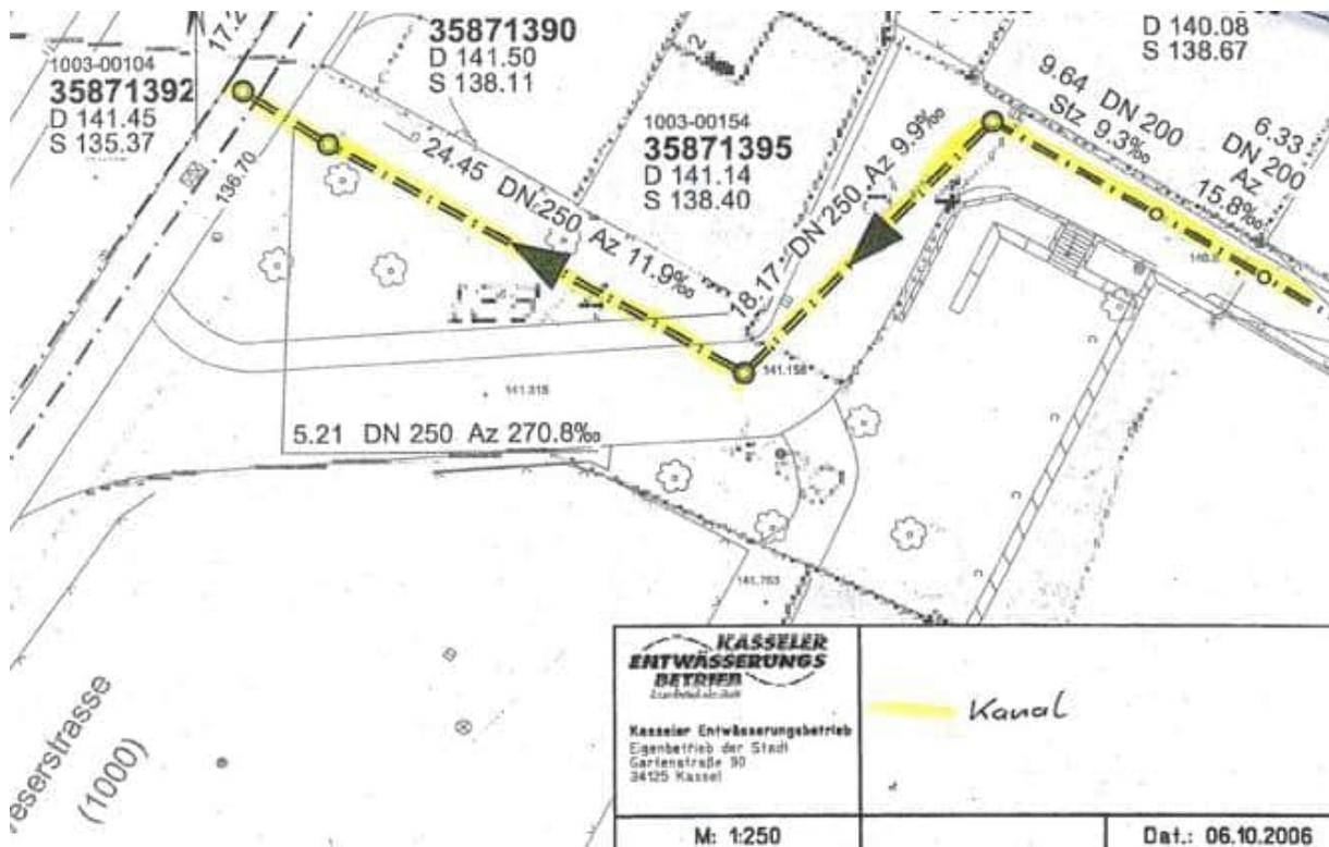
Abb. 24: Lageplan Mischwasserkanal
