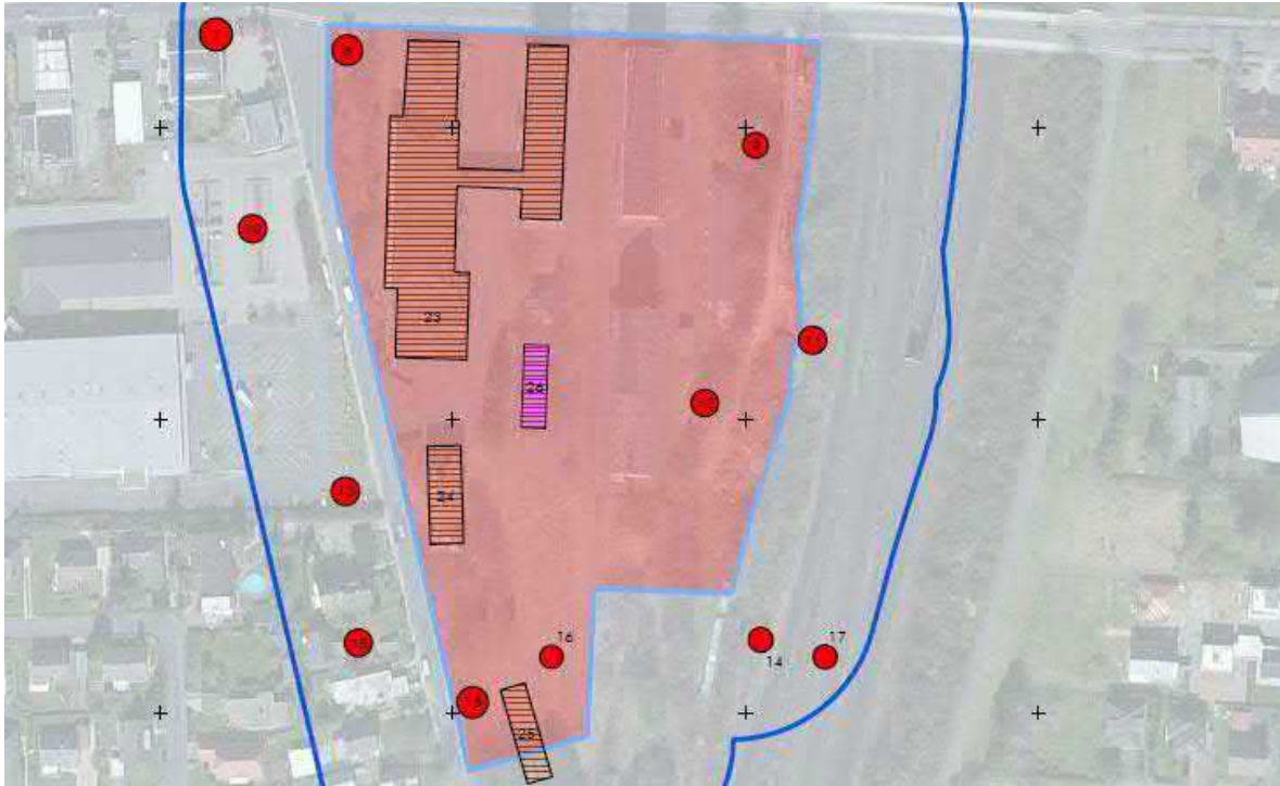
Abbildung 8: Kennzeichnung ermittelter Bombentrichter (rot) sowie der Sicherheitszone (rosa). Der Standort des Löschteichs entspricht der Fläche mit der Nr. 26.
