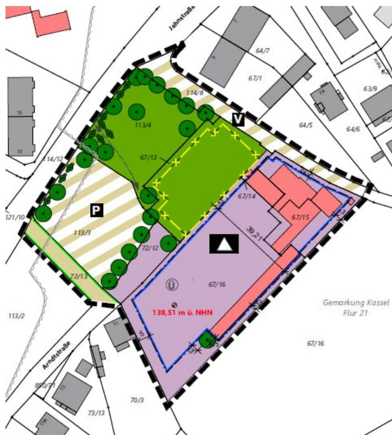
**Abb. 2-1: Abgrenzung des Geltungsbereiches (schwarz markiert) mit zum Erhalt festgesetzten Gehölze und Sporthallen-Abriss bzw. Neubauplanung (vgl. Text und BPlan-Entwurf).**
