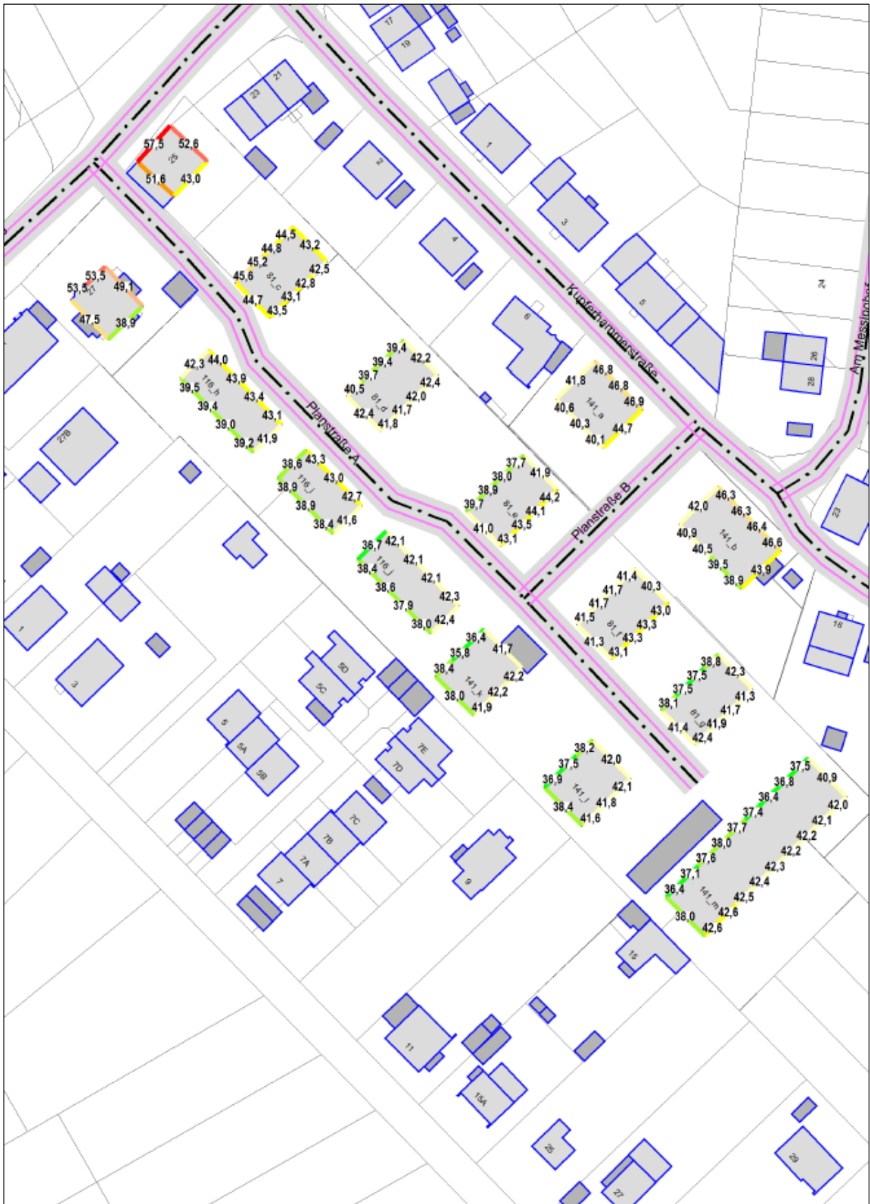
Abb. 7 Verkehrslärm, Beurteilungspegel im 1. OG an den Fassaden bei Nacht (Modus Consult, Karlsruhe, April 2014).
